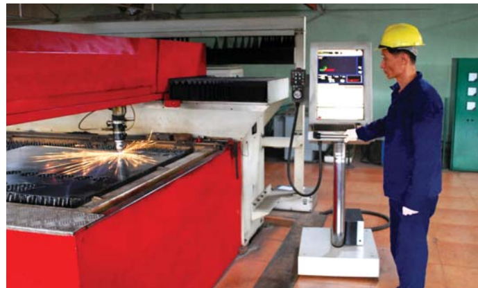
레이저절단기에 의한 철심생산
